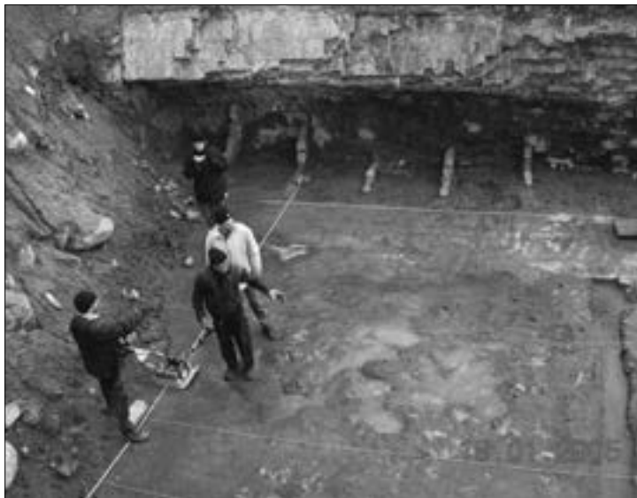
Рис. 4. Георадарные работы в подвале западного флигеля. Январь 2005 г. Фото С. А. Коваль
