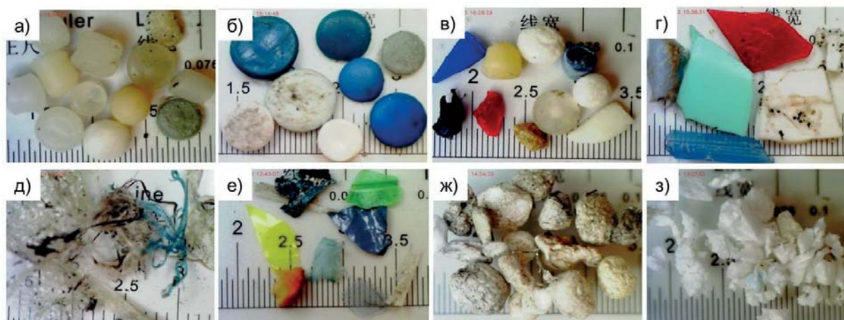
Рис. 2. Образцы микро/мезо пластика: А) промышленные пеллеты, Б) гранулы, В) фрагменты (лом), пеллеты, вспененный пластик (шарики пенопласта), Г) фрагменты (лом), Д) синтетические нити, Е) плёнки, Ж) вспененный пластик (деградировавшие шарики пенопласта), З) вспененный пластик (пенополистирол)
