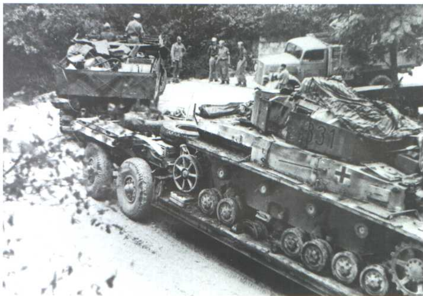
Uszkodzony czołg PzKpfw IV (Sd Kfz 161/1) Ausf. H z 16. DPanc na naczepie Sd Anh 116, Włochy, 1943 rok. A damaged PzKpfw IV (Sd Kfz 161/1) Ausf. H tank of the 16. Panzer Division on the Sd Anh 116 trailer, Italy, 1943 [ADM]
