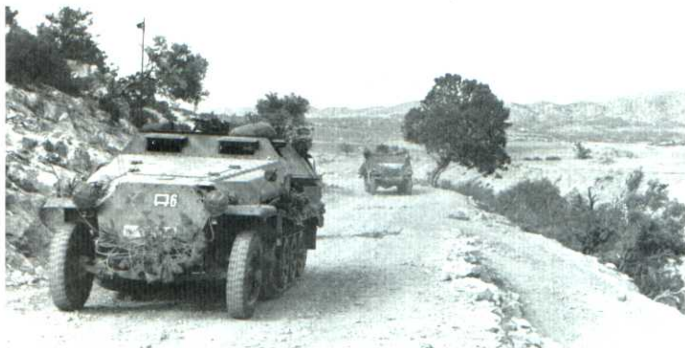
Sd Kfz 251/1 Ausf. C i zdobyczny amerykański M3 Halftrack z 10. DPanc, Kasserine, 1943 rok. Na transporterze namalowane godło dywizji. Sd Kfz 251/1 Ausf. C and a captured US M3 Halftrack, Kasserine, 1943. Note divisional symbol painted on the Sd Kfz 251/1 [Tank Museum]
