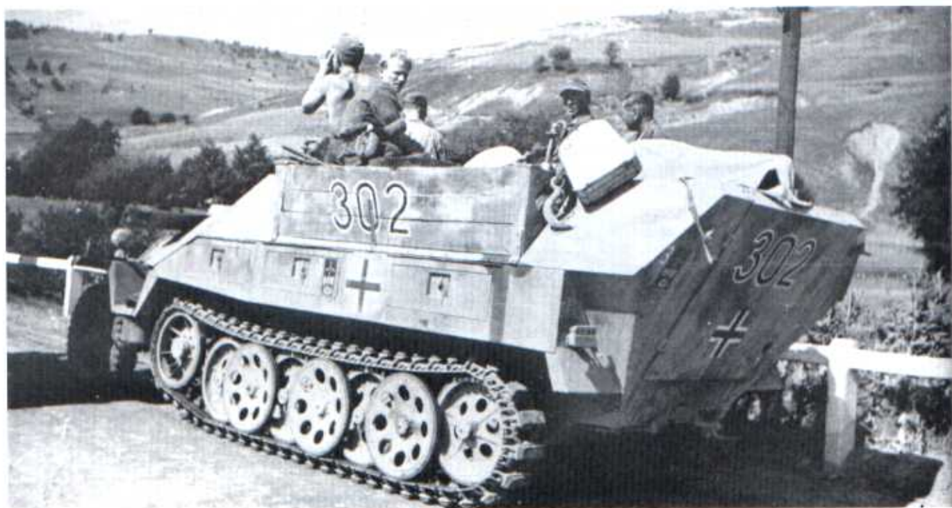
Sd Kfz 251/7 Ausf. D z 92. Batalionu Saperów, 20 DPanc, front wschodni, 1944 rok. Sd Kfz 251/7 Ausf. D of the 92. Pioniere Abteilung, 20. Panzer Division, Eastern Front, 1944
