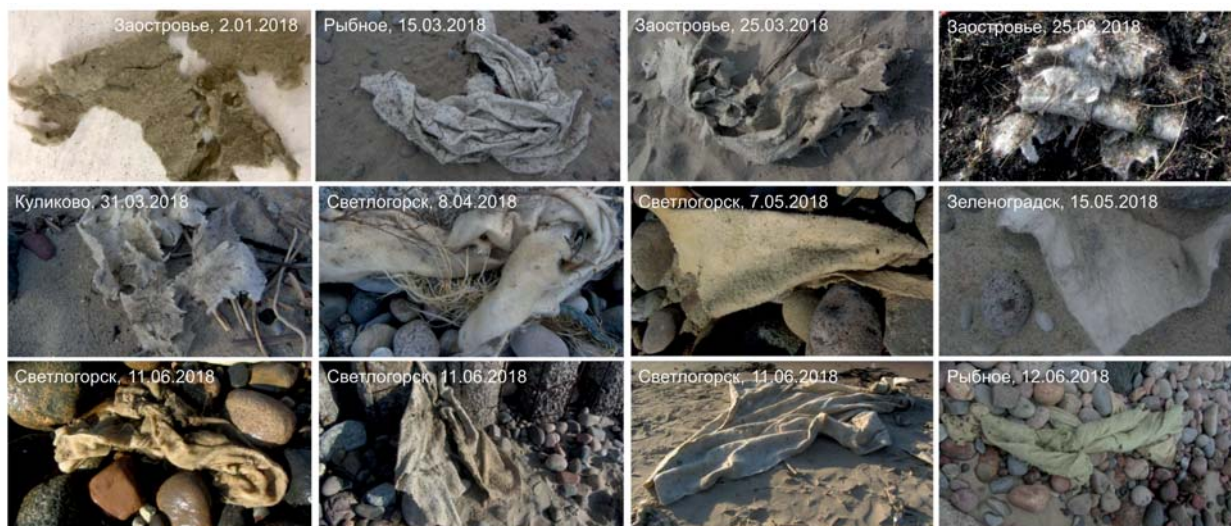
Рис. 9. Фрагменты нетканого иглопробивного геотекстиля типа Дорнит различной степени деградации на пляжах Калининградской области (фото Есюковой Е. Е.).
